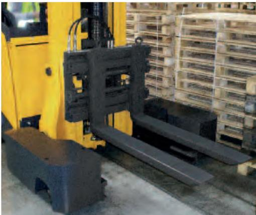
ZVKS, schmale Ausführung für Schubmaststapler
