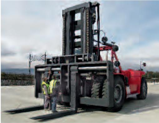
Zinkenverstellung – Tragfähigkeit 55.000 kg / 1200 mm
