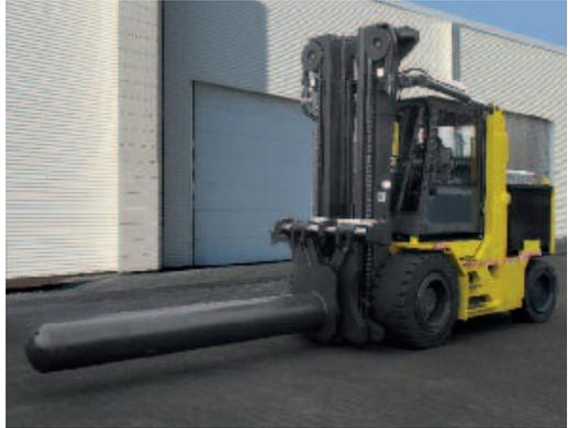
Hydraulisch teleskopierbarer Tragdorn
