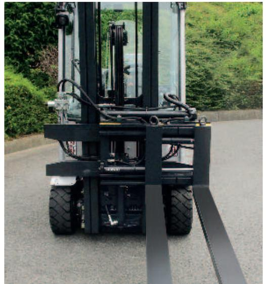
Containerseitenschieber in Kombination mit Sonder-Zinkenverstellung
