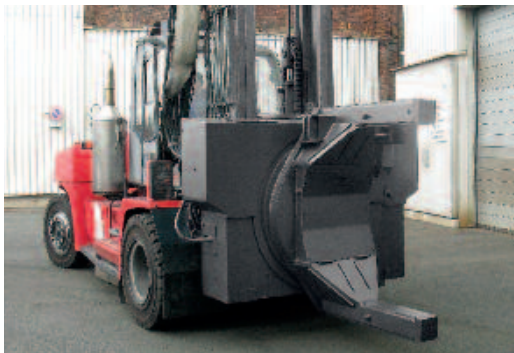
Drehgerät in Gießereiausführung mit Vollschutz und Konverteraufnahme
