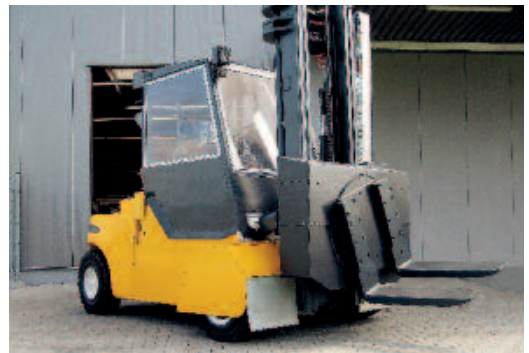
Drehgerät mit Seitenschub in Gießereiausführung und Wiegesystem
